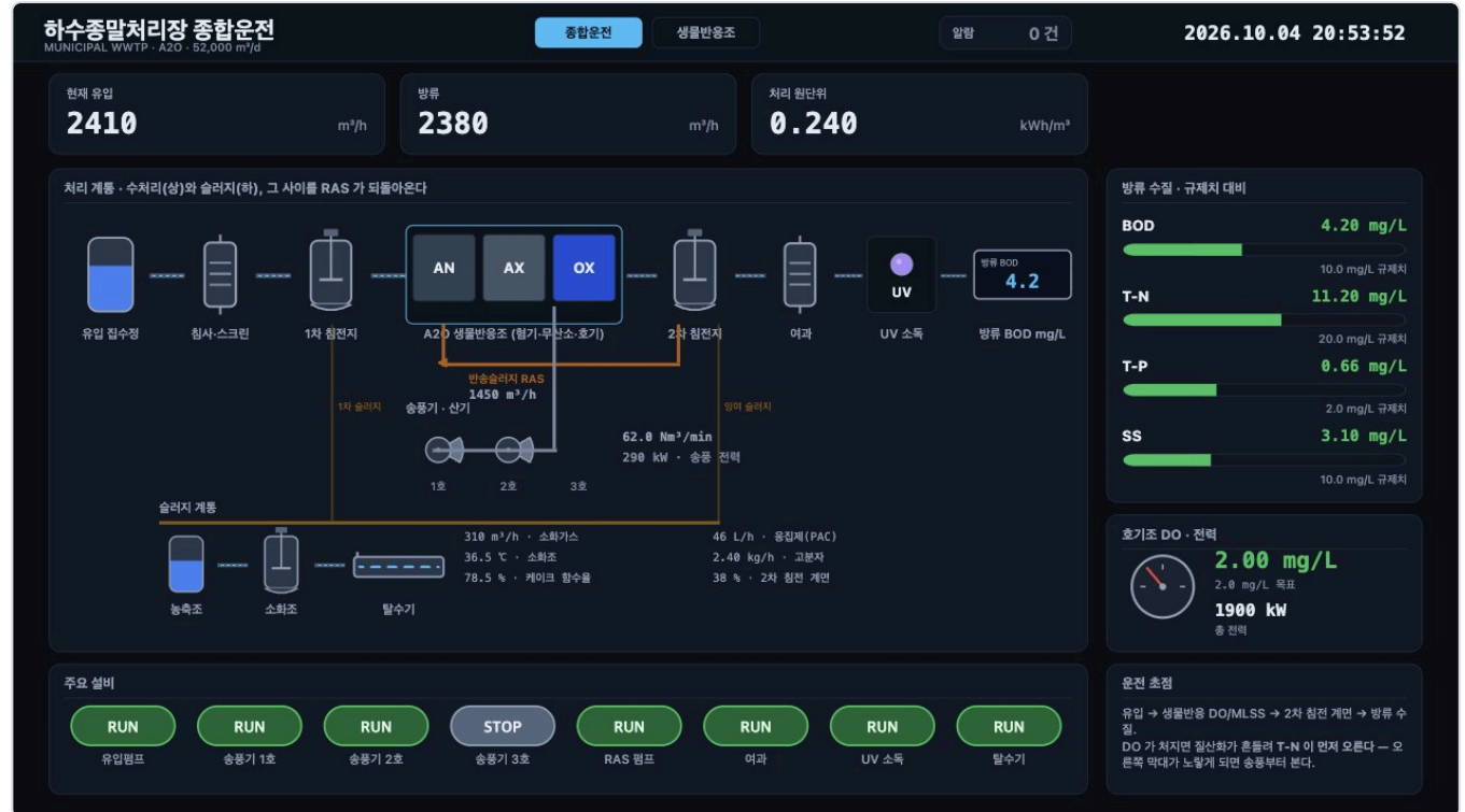
하수종말처리장 종합운전 — 수처리·슬러지 두 계통과 방류 수질
